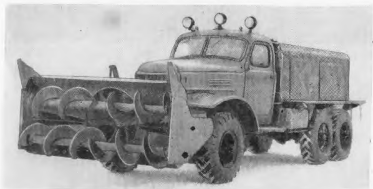
Рис. 141. Шнеко-роторный снегоочиститель Д-470
