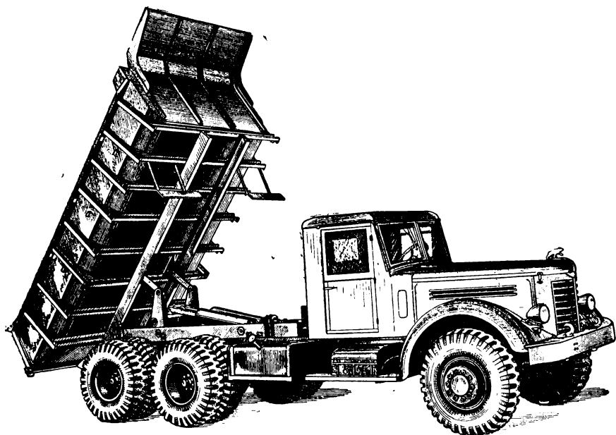
Фиг. 6. Общий вид автосамосвала ЯАЗ-210Е с поднятой платформой.
