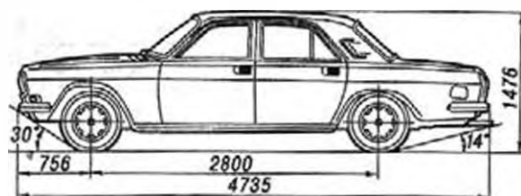
Рис. 1. Автомобиль ГАЗ-24-10 "Волга" и его габаритные размеры
