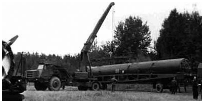
Войсковой гидравлический автокран 8Т26 с тягачом МоА3-546П на перегрузке ракеты Р-12
