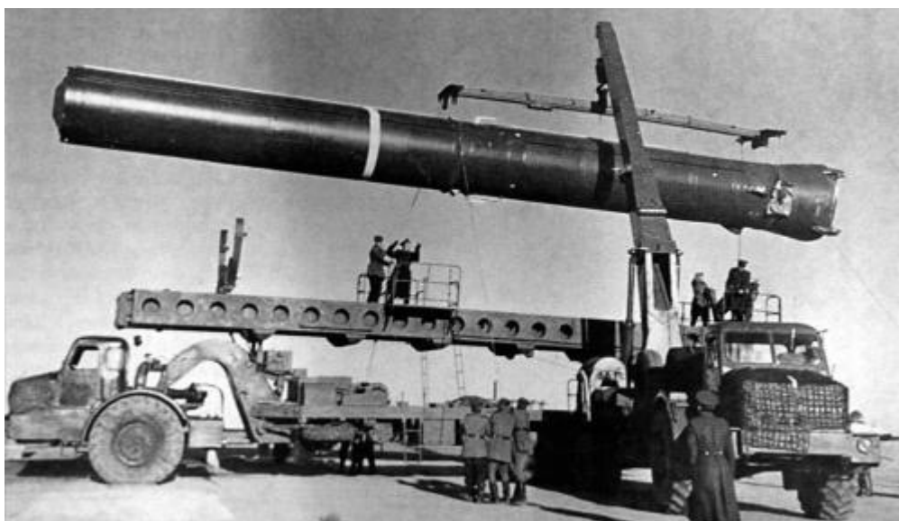
Установщик 8У237 ракеты Р-12У с тягачом МАЗ-529В, справа – автокран 8Т26. 1965 год
