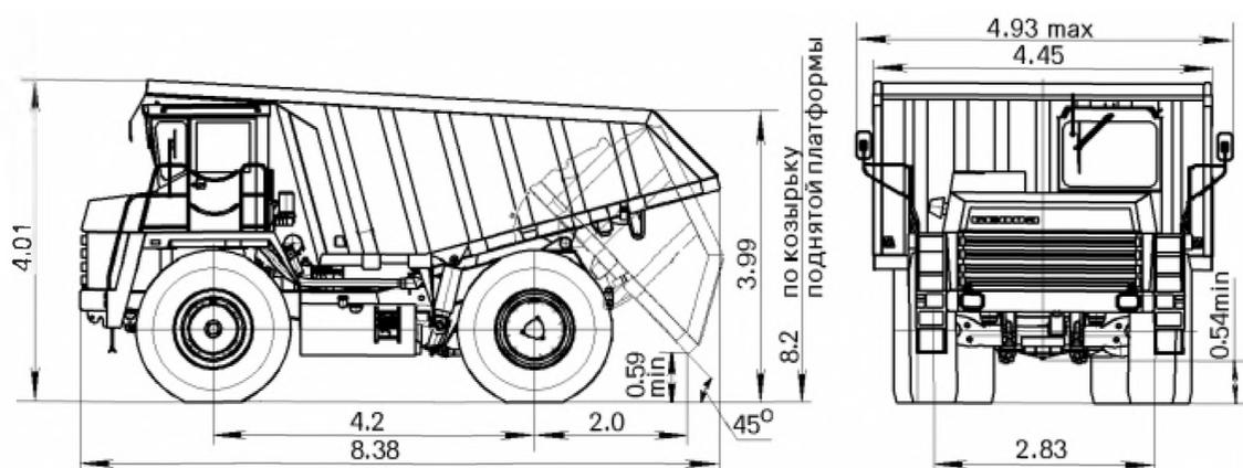
Рисунок 3.2 – Самосвал-углевоз БелАЗ-75479. Габаритные размеры
