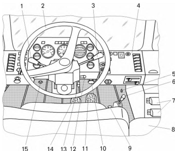
Рисунок 4.1 — Органы управления и оборудование кабины:
