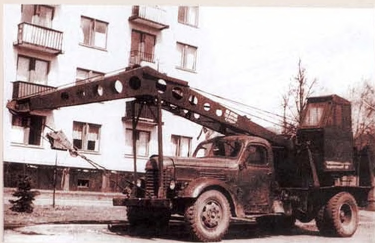
>>> Автокран Блейхерт - шасси наше, надстройка из ГДР
