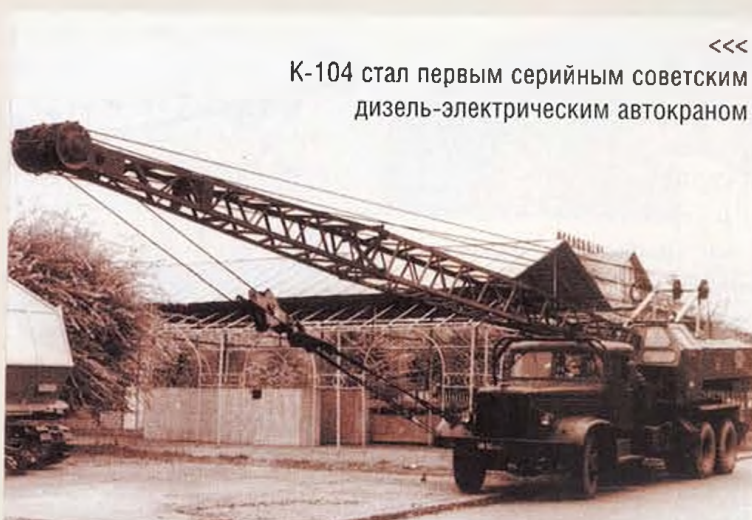
>>> Автокран Блейхерт - шасси наше, надстройка из ГДР
