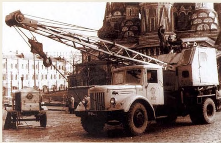
>>> Ивановцы модернизировали К-51, увеличив грузоподъемность К-53 (на снимке) до 7,5 т
