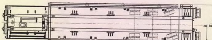
Вариант исполнения с каркасом, тентом, дополнительными бортами на рабочей площадке, трапами с гидравлическим приводом
