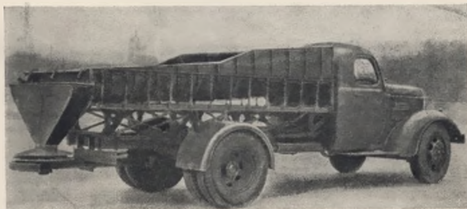
Рис. 5. Общий вид механического пескоразбрасывателя «МП-1» в транспортном положении.
