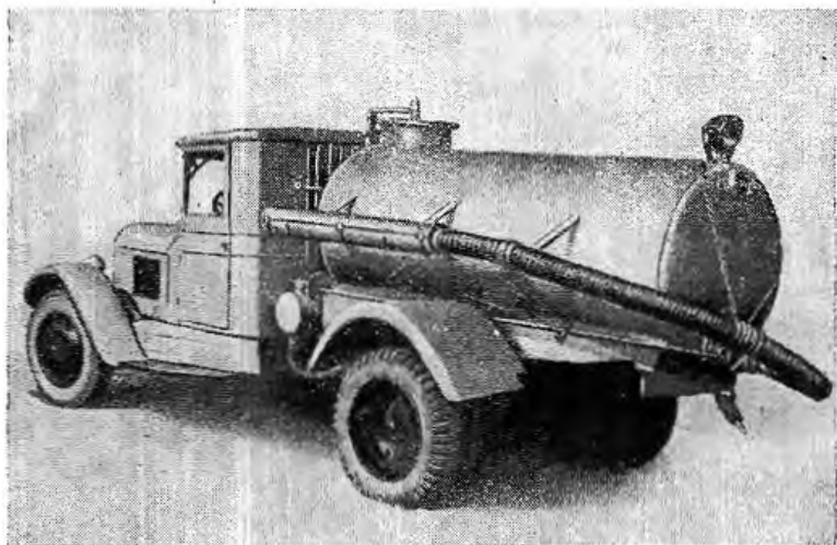
Рис. 1 Ассенизационная машина АСМ на шасси автомобиля ЗИС-5.
