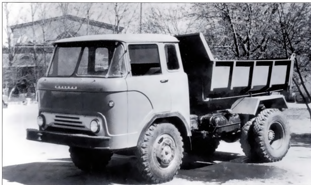
▲ Самосвал на шасси седельного тягача КАЗ-608 изготовлялся серийно на Тосненском ремонтном заводе в Ленинградской области. Фото А. Гонтарева
