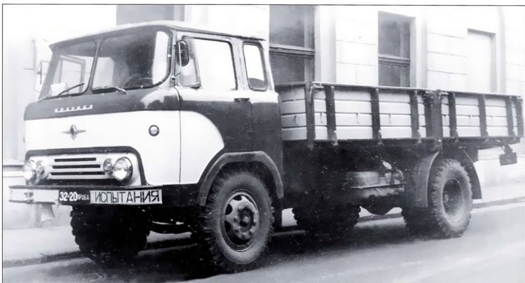
▲ Бортовой автомобиль КАЗ-605 с металлической грузовой платформой, по форме бортов унифицированной с полуприцепом КАЗ-717. Обратите внимание на упрощенное боковое окошко кабины после водительской двери – оно характерно для всех автомобилей КАЗ-608 поздних серий. Фотография сделана в Москве А. Новиковым
