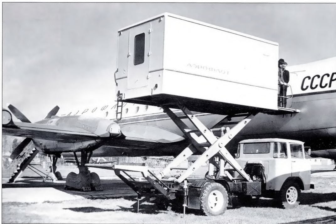
▲ Автолифты предназначались для обслуживания самолетов гражданской авиации, так как обычные грузовики до них уже не дотягивались
