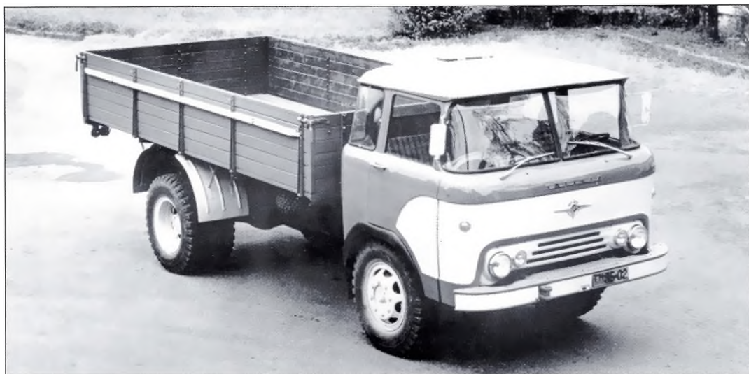
▲ Опытный автомобиль КАЗ-605, унифицированный с тягачом КАЗ-608 (возможно, что его правильный индекс КАЗ-607). На этой машине стоит кабина с единственным вентиляционным лючком в крыше над спальным местом и грузовая платформа с деревянными бортами
