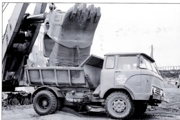
«Еще один самосвал от «ремза-вода», также выполненный на шасси бывшего седельного тягача КАЗ-608. Фото из архива А. Дюпуи»
