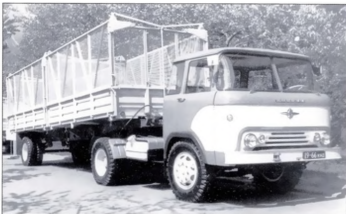
« Опытный автомобиль КАЗ-608 с самосвальным полуприцепом для перевозки хлопка ТМЗ-879, который выпускал с 1963 г. Ташкентский завод «Ташавтомаш». Фото А. Новикова
