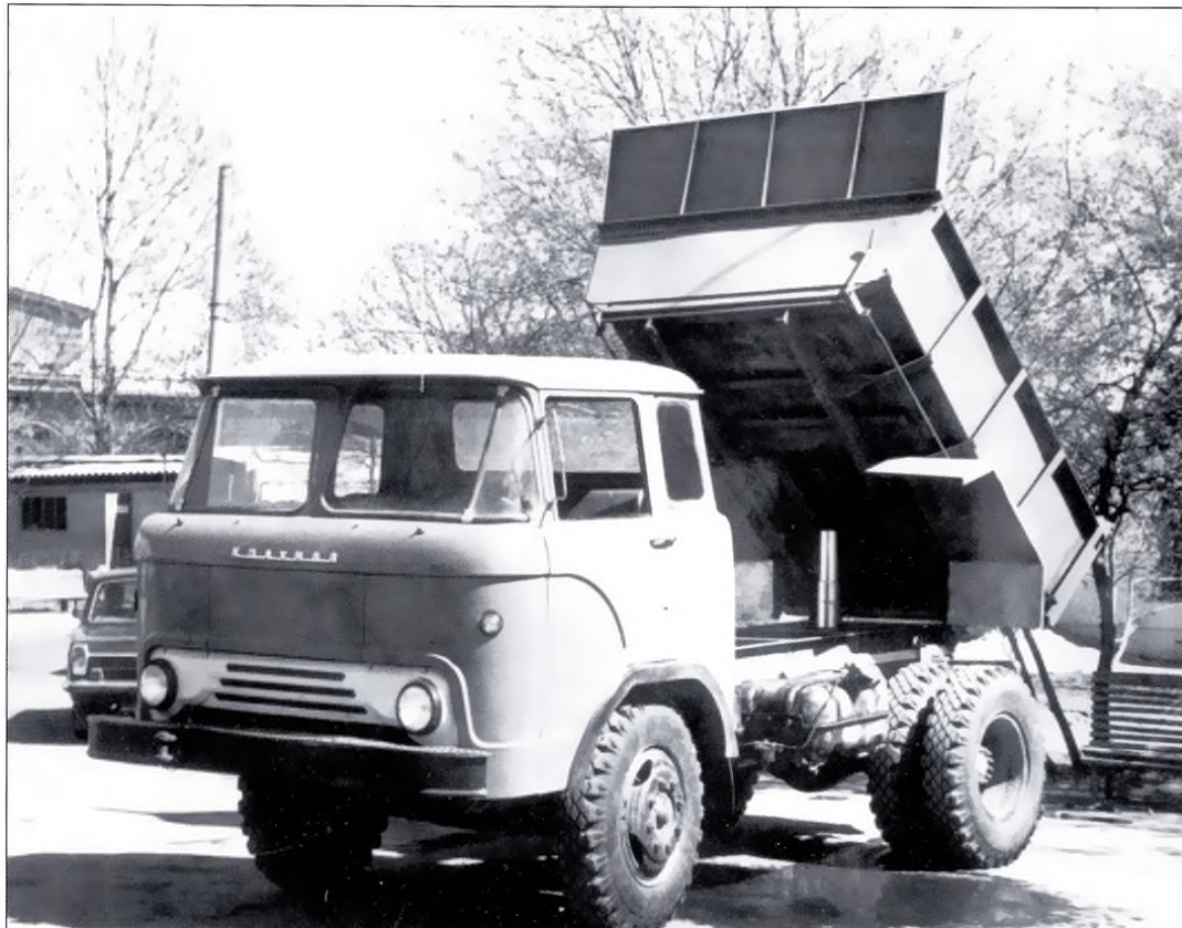
▲ Самосвал на шасси седельного тягача КАЗ-608 изготовлялся серийно на Тосненском ремонтном заводе в Ленинградской области. Фото А. Гонтарева
