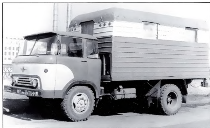
▲ Один из опытных бортовых автомобилей КАЗ-605 был превращен на заводе в техничку для сопровождения автомобилей «Колхида» на испытаниях. Фото А. Новикова
