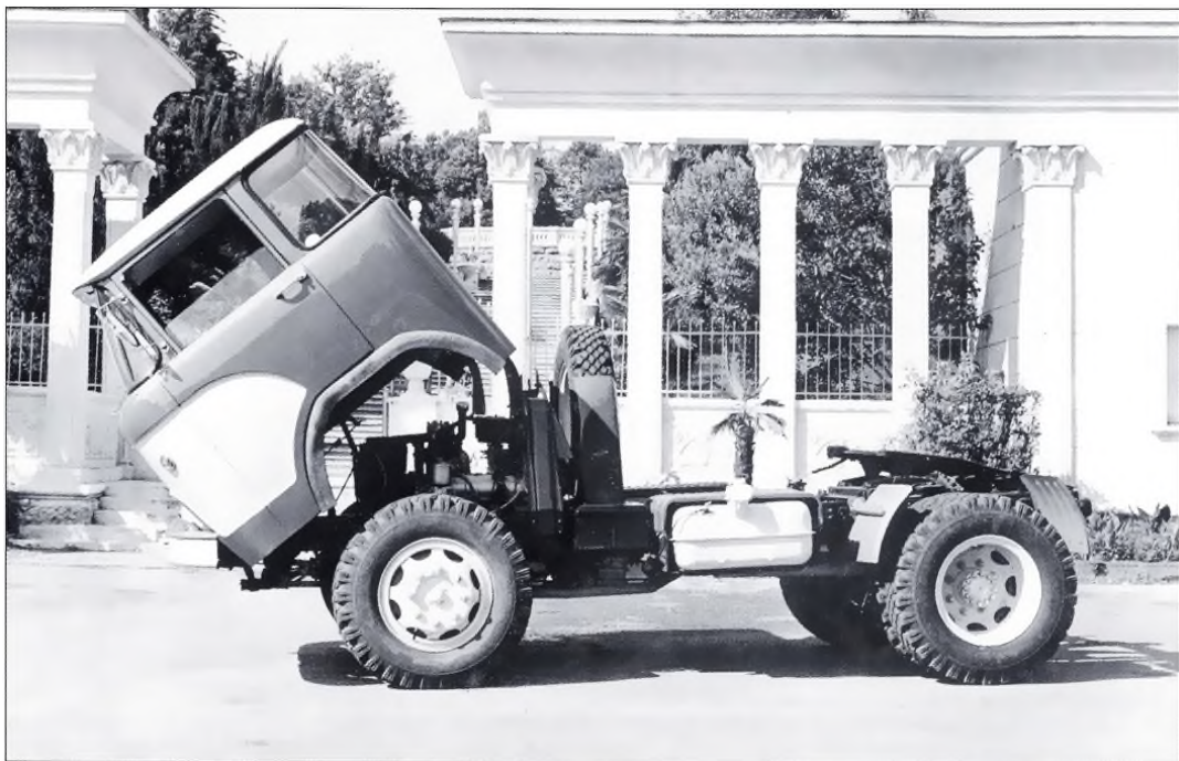
▲ На КАЗ-608 кабина получила возможность откидываться вперед для доступа к двигателю
