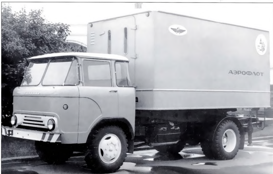
▲ Аэродромный автолифт АЛ-3 на удлиненном шасси КАЗ-608 «Колхида» на ВДНХ СССР. Фото А. Новикова
