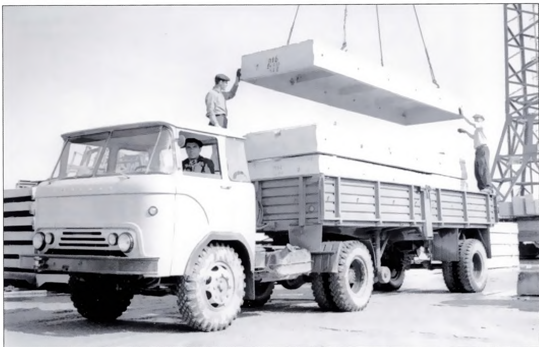
▲ Явно постановочный рекламный кадр – на снимке автомобиль КАЗ-608 первых выпусков со снятыми государственными номерными знаками пытаются загрузить свыше всякой нормы бетонными перекрытиями
