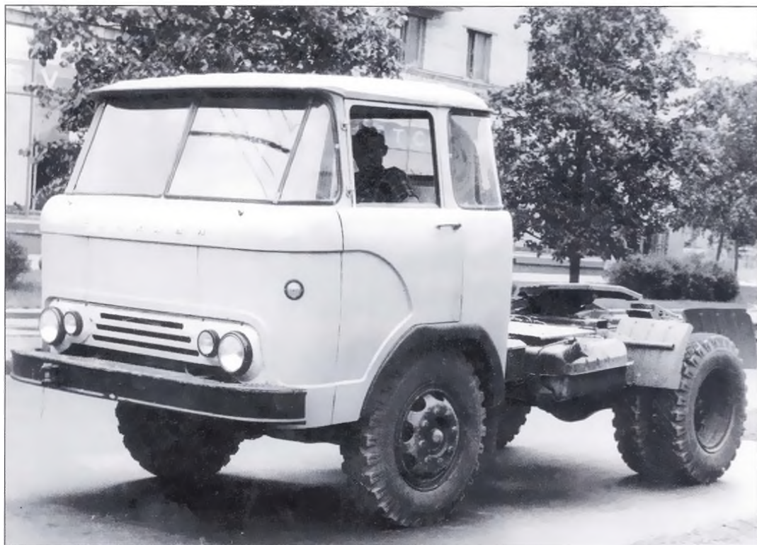
▲ Серийный автомобиль КАЗ-608 первых выпусков. На автомобиле еще присутствуют противотуманные фары и брызговики задних колес. Фото А. Новикова
