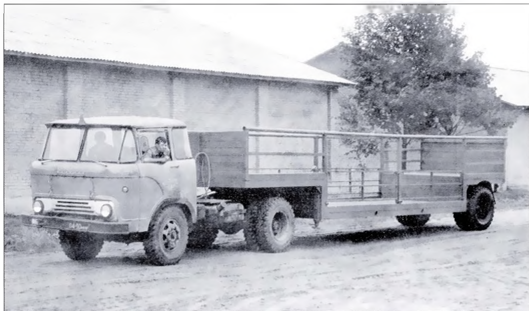
▲ Автомобиль КАЗ-608 с полуприцепом производства Бобруйского завода нестандартного оборудования для перевозки специальных овощных контейнеров
