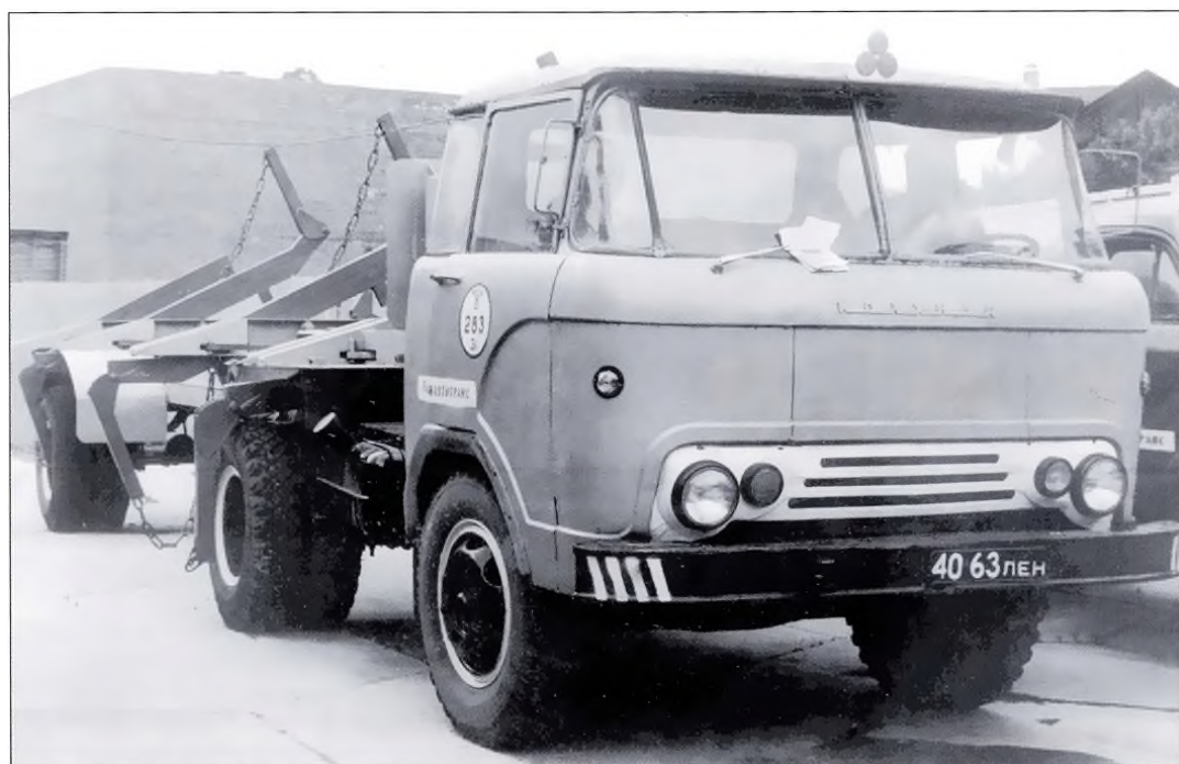
▲ Саморазгружающийся полуприцеп-металловоз производства Ленинградского Глававтотранса в сцепке с тягачом КАЗ-608 ранних выпусков. Фото А. Новикова
