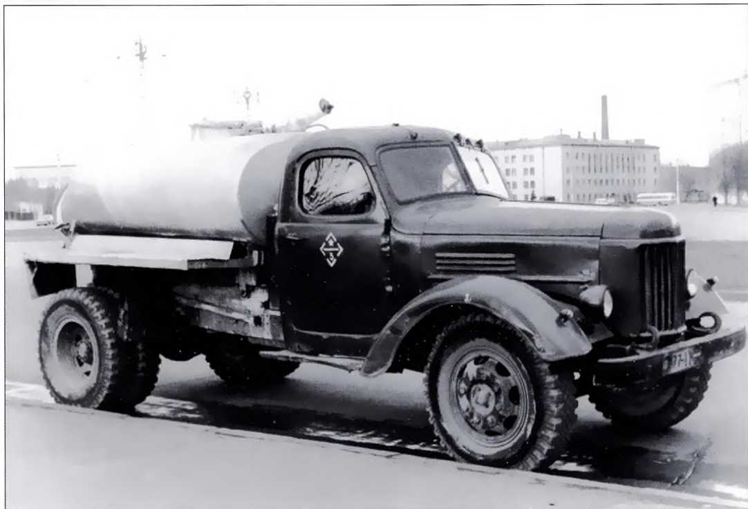
▲ На улицах цементовозы редко выглядели красивыми – тяжелые условия эксплуатации на стройках страны не способствовали красоте. Этот КАЗ-601В на шасси ЗИЛ-164Г работал у военных строителей (стройбат). Фото А. Новикова
