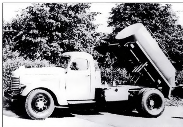
◀◀ Еще один опытный цементовоз КАЗ-601 с откинутой назад цистерной. Видно, что для опрокидывания цистерны еще используются два спаренных простых цилиндра, как на самосвале КАЗ-585Б, чего на серийных машинах никогда не было. Фото из архива А. Исаева
