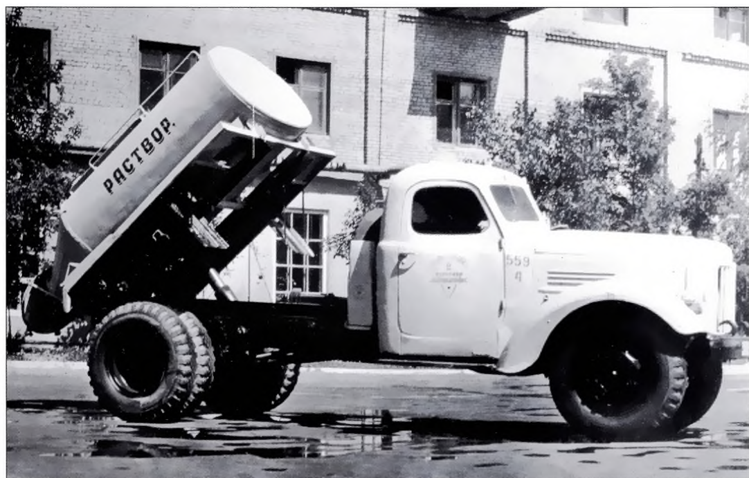
▲ Цементовоз КАЗ-601В, переделанный на автобазе № 2 Мосстройтранса в растворовоз РС-2,5
