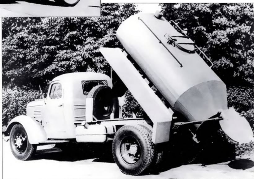
◀◀ Еще один опытный цементовоз КАЗ-601 с откинутой назад цистерной. Видно, что для опрокидывания цистерны еще используются два спаренных простых цилиндра, как на самосвале КАЗ-585Б, чего на серийных машинах никогда не было. Фото из архива А. Исаева
