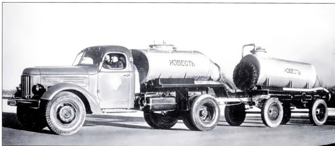
▲ Автомобиль КАЗ-601В, переделанный на 16-й автобазе Мосстройтранса из цементовоза в автопоезд для перевозки строительных известковых растворов
