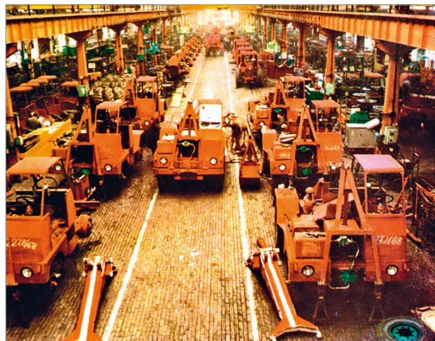
7. ábra FRAK-B1 forgórakodó dömperek a szerelősoron
