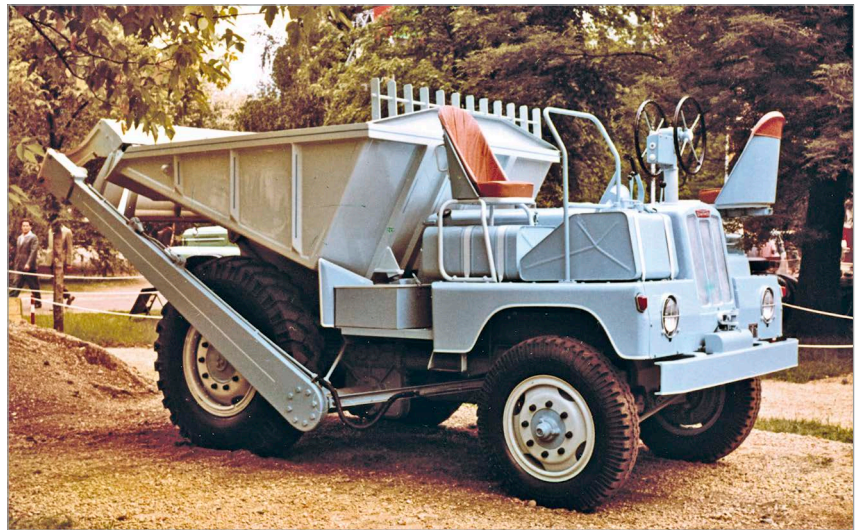
2. ábra DR-50/ÖDA (DUTRA 3100-3101) jelű önrakodó dömper, 1969
