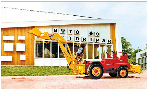
6. ábra A DUTRA-3500 eszközhordozó FRAK alapgép STAGE árokásával és frontális tolólappal, 1970
