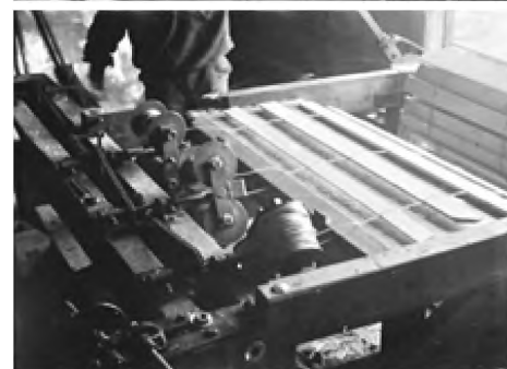
Arnold Volbergi konstrueeritud masin lumetõrjeaja valmistamiseks.
