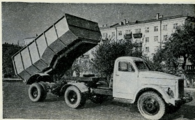
Рис. 5. Автомобиль-самосвал в составе автомобиля ГАЗ-М с полуприцепом-самосвалом.
