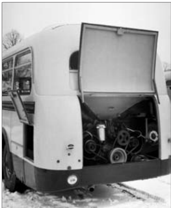
Osmiválcový motor T 108 zabudovaný v zádi autobusu Tatra HB 500
