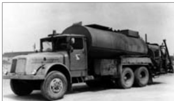
Finišer na převoz roztavené pryskyřice na podvozku Tatra 111
