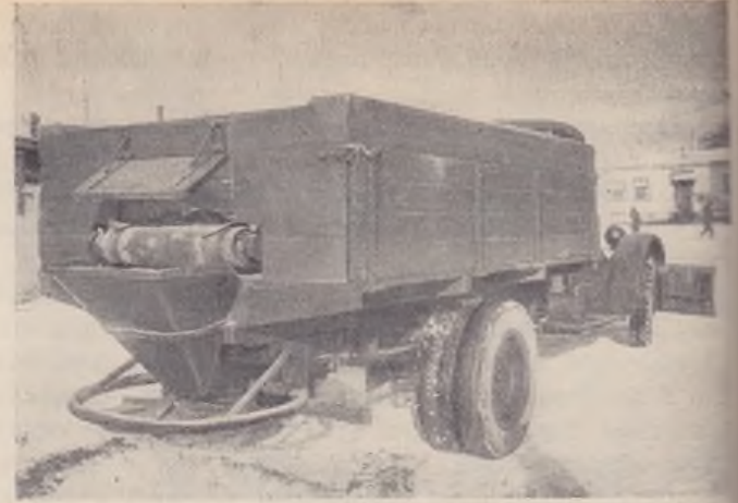
Реконструированный пескоразбрасыватель «ПД» с малым плугом (вид сзади).
