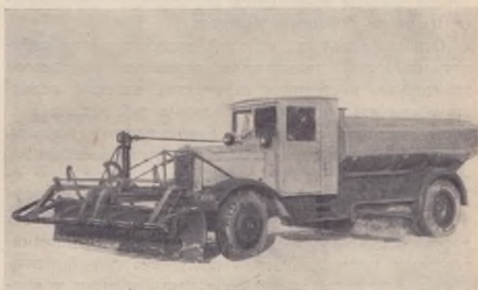
Поливо-моечная машина «ЯГ-6» с большим плугом и круглой сеткой.
