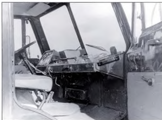
▲ Кабина у КАЗ-608В стала просторнее и удобнее, по сравнению с предшественником. Фото из архива НИЦИАМТ НАМИ
