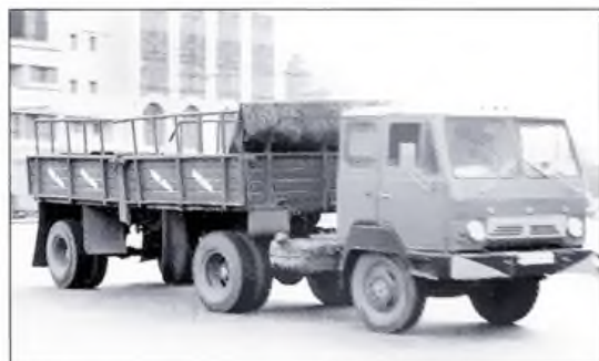
▲ Тягач КАЗ-608В с полуприцепом ОдАЗ-885 для перевозки почтовых контейнеров в Москве. Фото О. Чалкова
