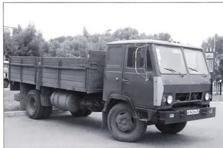
▲ Бортовой грузовик на удлиненном шасси КАЗ-608В. Иногда такие машины с удлиненной базой обозначали как КАЗ-608Г по аналогии с ЗИЛ-130Г. Фото А. Коновалова
