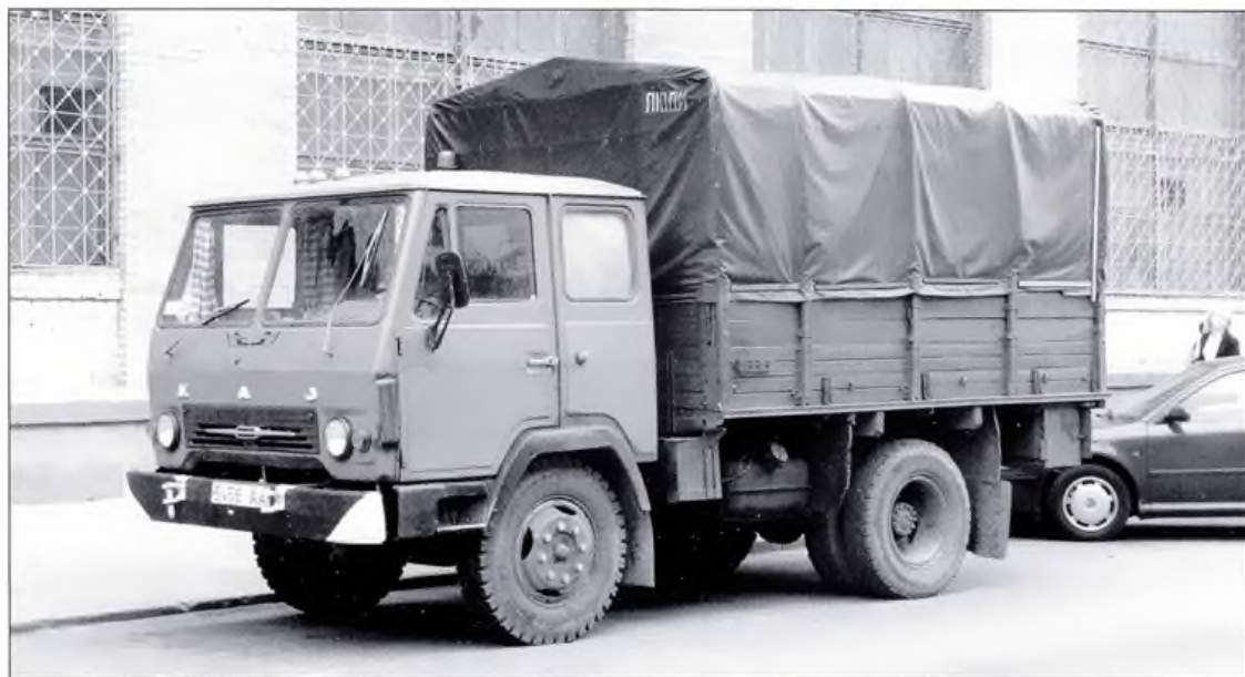
▲ Самодельный бортовой автомобиль на стандартном шасси седельного тягача КАЗ-608В (Беларусь). Фото Д. Гладкого
