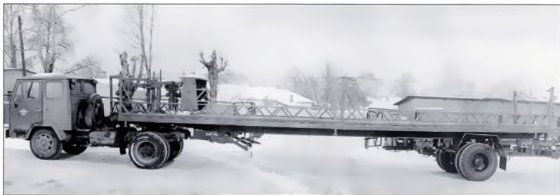
▲ КАЗ-608В с полуприцепом для длинномерных грузов производства Бобруйского опытно-механического завода
