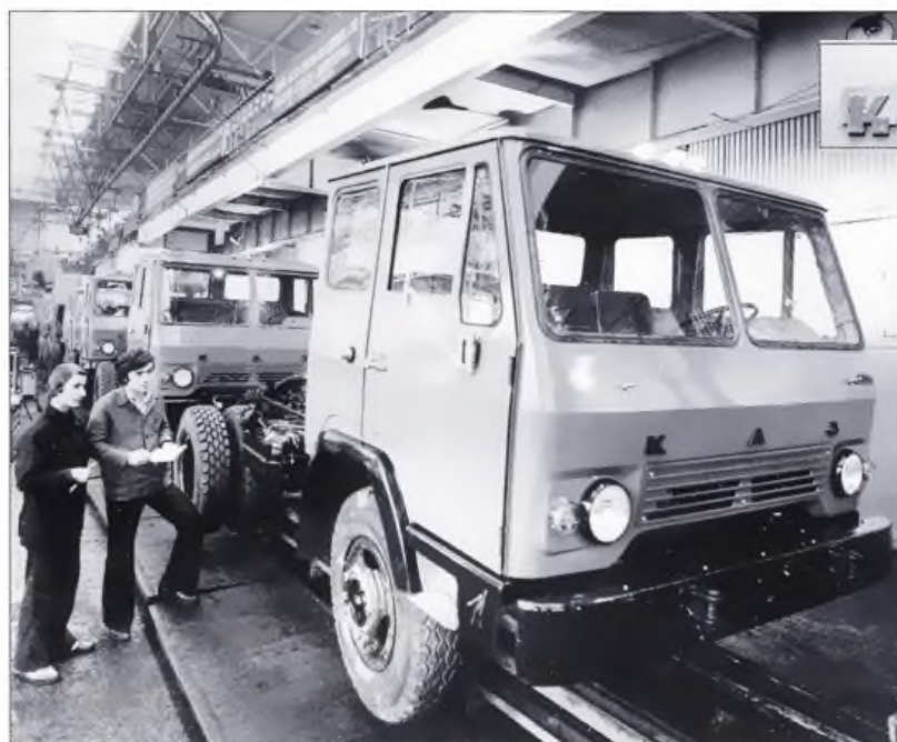
«Сборка автомобилей КАЗ-608В на главном конвейере Кутаисского автозавода. Снимок сделан 5 марта 1980 г. Фото из РГАКФД»
