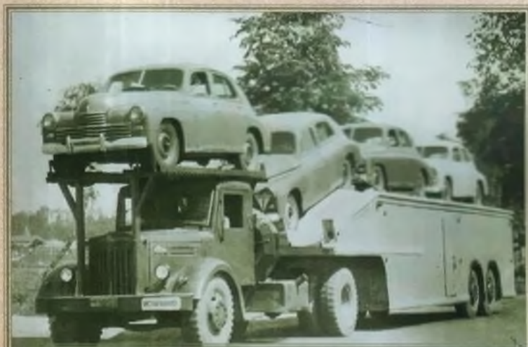
Автопоезд загружен шестью автомобилями Победа, из которых два находятся внутри фургона, на первом ярусе
