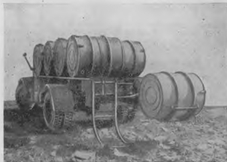
Рис. 12. Погрузка контейнера на контейнерную машину МКМ-3.
