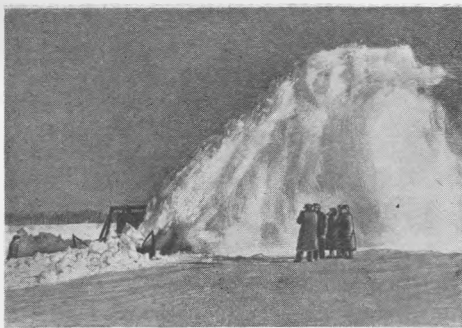
Рис. 5. Снегоочиститель Д-166 на уборке снегового вала общен высотой 1,5 м
