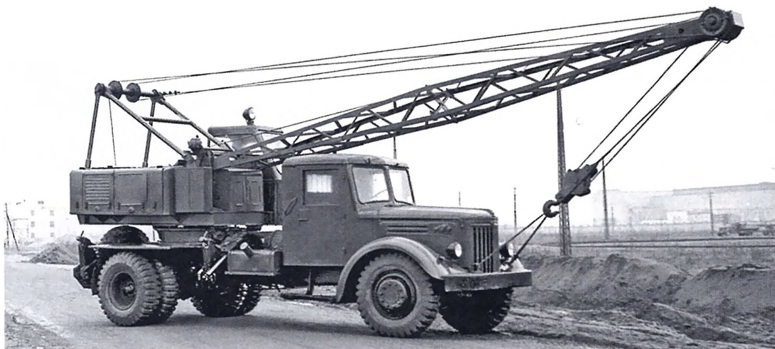
Экземпляр серийного автокрана К-52 на шасси позднего МАЗ-200 в транспортном положении, вид справа-спереди
