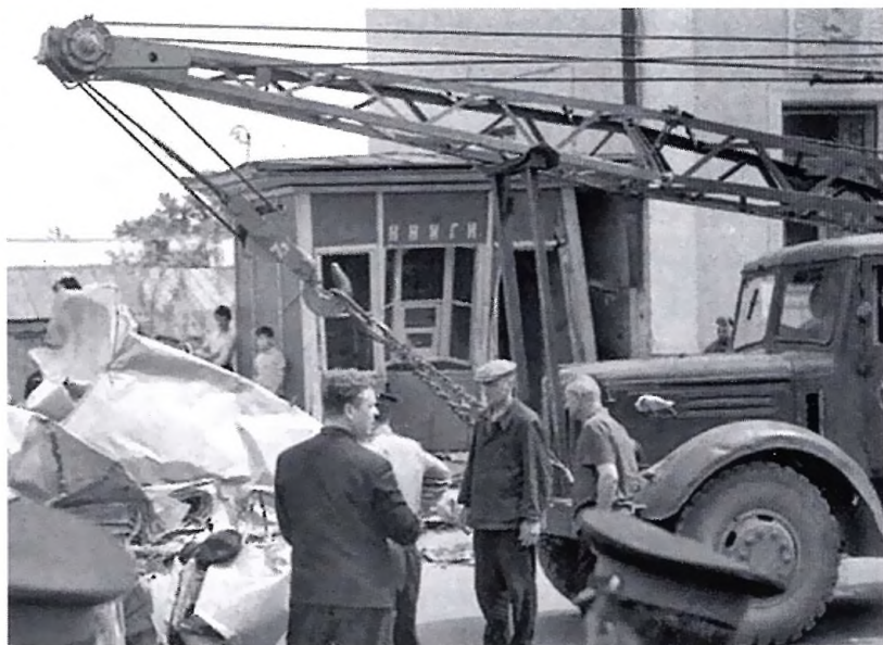
Экземпляр автокрана К-69А с дополнительной стойкой у бампера на шасси МАЗ-200П в ходе ликвидации последствий крупного ДТП в г. Липецке летом 1966 г. На перекрестке ул. Первомайской и ул. Фрунзе трамвай с отказавшими тормозами буквально раздавил «Волгу» ГАЗ-21Р и разрушил книжный киоск
