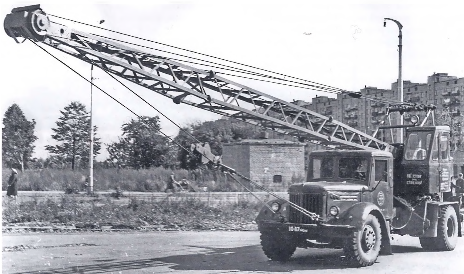
Еще один экземпляр позднего автокрана К-52 (8Т-211) на шасси МАЗ-200П, № 10-87 моо, с удлиненной стрелой в транспортном положении, вид слева-спереди. Москва, начало 1970-х гг.
