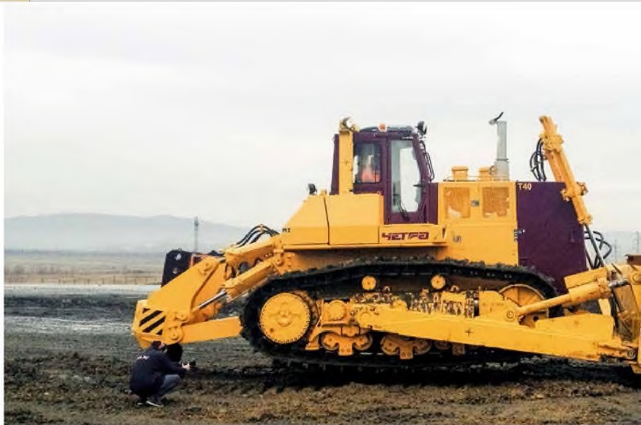
На снимке: ▶ многотонная машина с легкостью «отжимается» на отвале и рыхлителе
