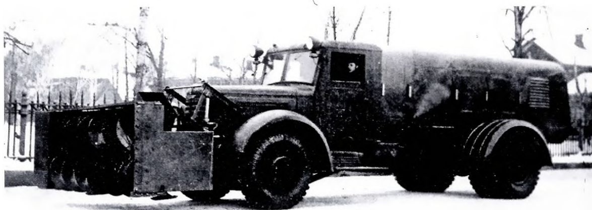
Усовершенствованный шнекороторный снегоочиститель Д-166А на шасси ЯАЗ-200
