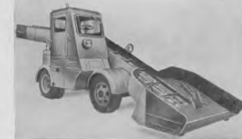
Фиг. 21. Погрузчик снега С-4 на шасси автомобиля ГАЗ-51.
