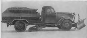
Фиг. 22. Пескоразбрасыватель Д-307А на шасси автомобиля ЗИЛ-104 с муфтами-шестернями снегоочистительным оборудованием
