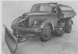
Фиг. 10. Плужно-щеточное снегоочистительное оборудование на поливочно-мочной машине ПМ-20.
