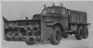
Фиг. 15. Шнеко-роторный снегоочиститель Д-470 на шасси автомобиля ЗИЛ-157.
