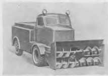
Фиг. 16. Шнеко-роторный снегоочиститель РС-2М на шасси автомобиля ЗИЛ-164.
