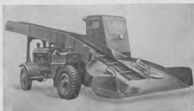
Фиг. 20. Погрузчик снега Д-460 на специальном шасси Д-452.
