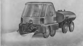
Фиг. 19. Машина Т-30 для уборки тротуаров на малогабаритном тягаче
