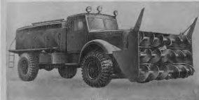
Фиг. 14. Шнеко-роторный снегоочиститель Д-450 на шасси автомобиля МА3-502.
