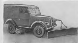
Фиг. 18. Машина Т-3 для уборки тротуаров на шасси автомобиля ГАЗ-69.
