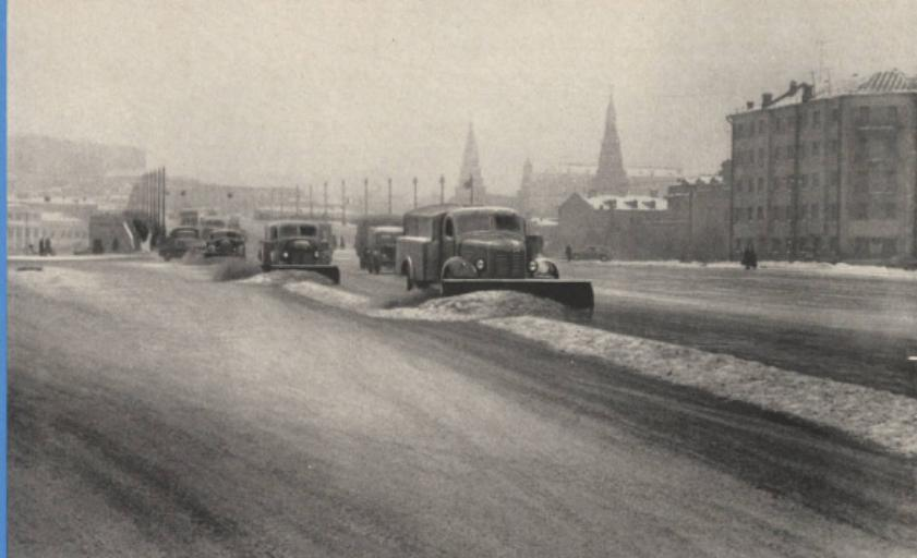
Подметальное устройство устанавливается под машиной между передней и задней осями и состоит из щетки и механизмов привода и подъема щетки в транспортное положение. Привод щетки осуществляется от двигателя автомобиля через коробку отбора мощности. Управление механизмами снегоочистительного оборудования, а также подъем и опускание плуга и щетки производится водителем из кабины.
