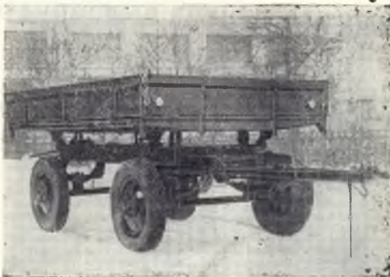
Автомобильный прицеп-самосвал ММЗ-764. Опытный образец.
