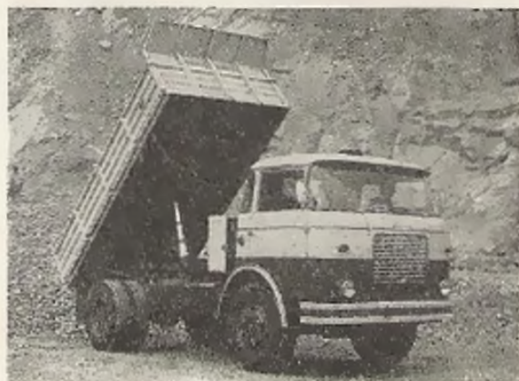
Sklápěč Škoda 706 MTS 24 s třístranným kapalinovým sklápěcím zařízením, pro přepravu sypkých hmot. Je určen zvláště pro zemní a stavební práce.
