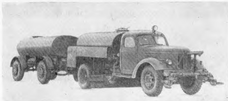
Рис. 139. Комбинированная поливо-моечная машина КПМ-2
