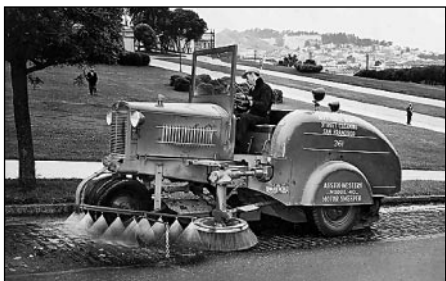
Рис. 10. Подметально-уборочная машина США модели 40, работающая в Сан-Франциско (1948 г.)
