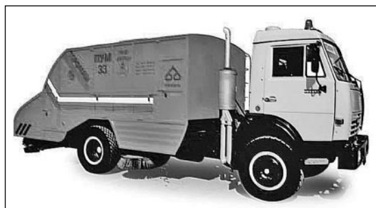
Рис. 22. Машина ПУМ-33 на шасси КАМАЗ-43253
