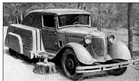
Рис. 14. Подметально-уборочная машина ПУ-6 на шасси ГАЗ-11-73 (ГАЗ-М1)
