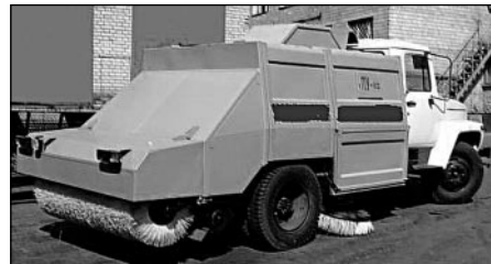
Рис. 19. Машина ПУ-93 на шасси ГАЗ-3307
