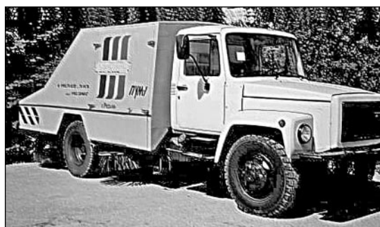
Рис. 21. Машина ПУМ-1 на шасси ГАЗ-3307
