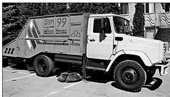
Рис. 23. Машина ПУМ-99 на шасси ЗИЛ-433362
