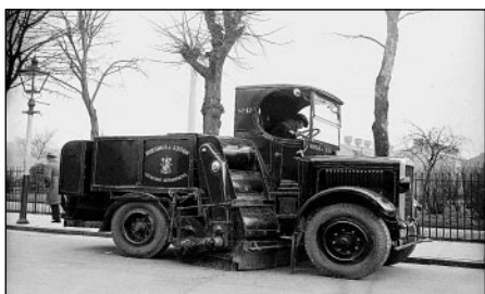
Рис. 9. Подметально-уборочная машина, работающая в г. Вене (1936 г.)
