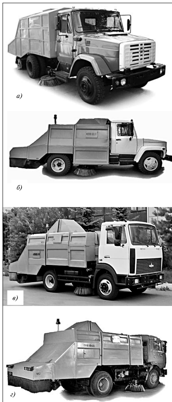
Рис. 24. Подметально-уборочные машины ПУМ-69 (а), ПУМ-69.01 (б), ПУМ-69.02 (в) и ПУМ-69.03 (г)
