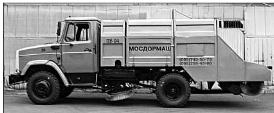
Рис. 20. Машина ПУ-94 на шасси ЗИЛ-433362
