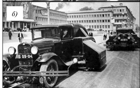
Рис. 12. Подметально-уборочная машина ПУ-8 на шасси ГАЗ-ММ, работающая в Москве (а) и Ленинграде (б)
