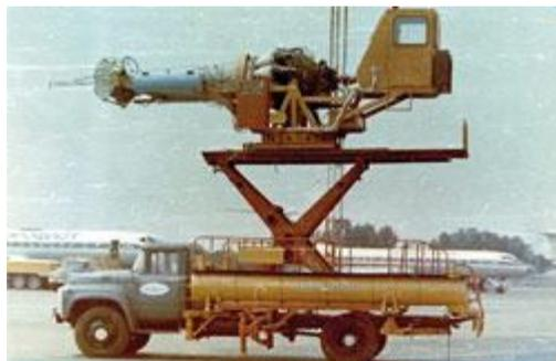
Установка предназначена для удаления льда, инея или снега с поверхностей самолетов воздействием газоздушного потока, в качестве генератора которого использован авиационный турбореактивный двигатель, установленный на самоходном шасси. Установка оборудована необходимыми системами управления работой турбореактивного двигателя, а специальная рама обеспечивает его подъем на высоту и поворот в горизонтальной плоскости.
