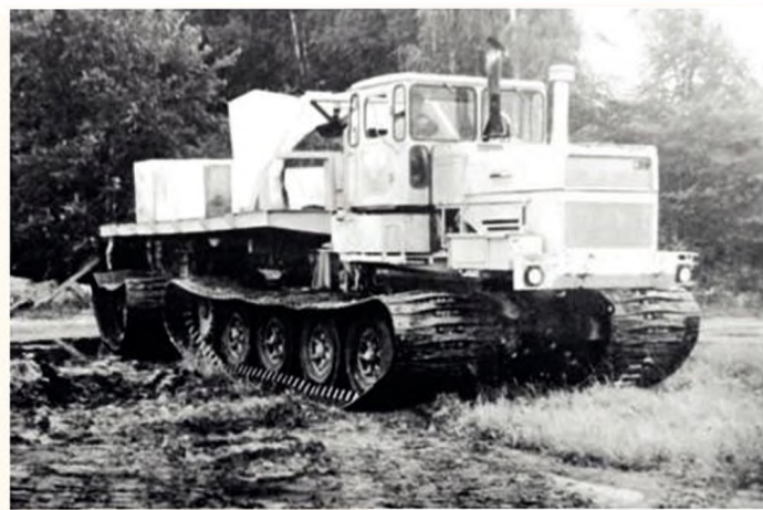
В основе появившейся во второй половине 1970-х «Тюмени» – агрегатная база трактора «Кировец»
