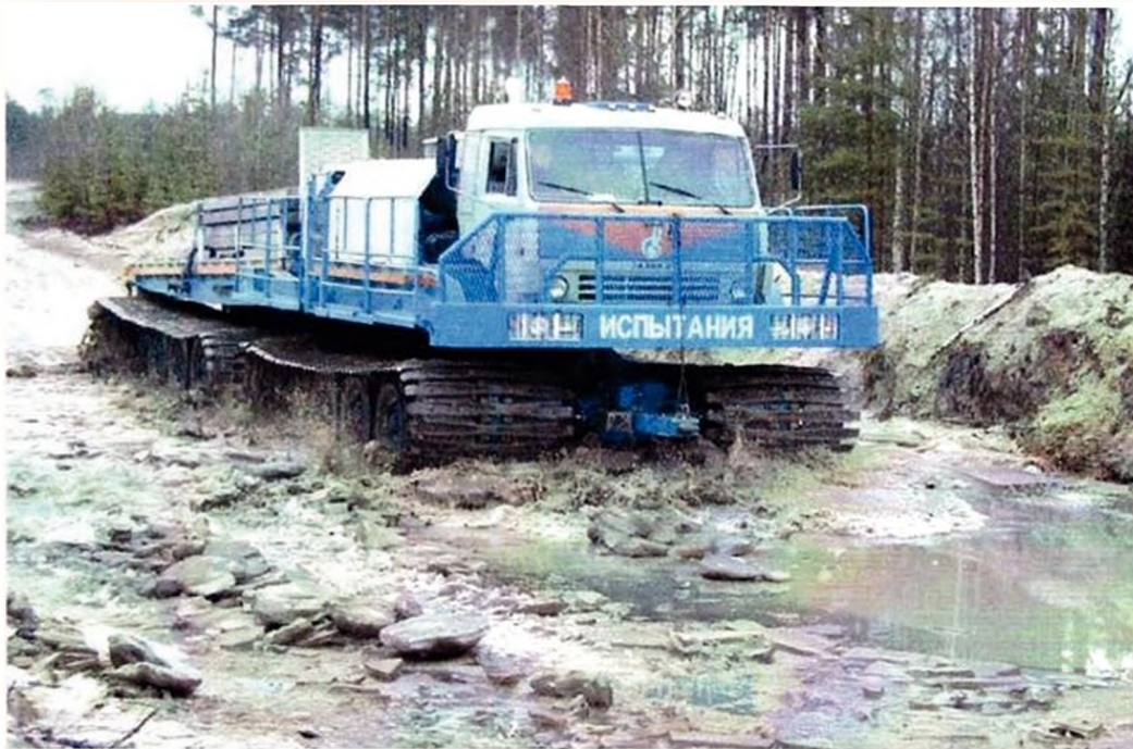
«ЕРМАН-500» оснастили 12-цилиндровым дизелем ЯМЗ-240НМ2 мощностью 500 л.с. и гидромеханической трансмиссией, разработанной чебоксарским «Промтрактором»
