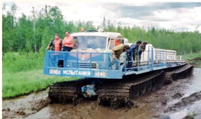
«ЕРМАН-500», он же ШСГ401: шасси снегоболотоходное гусеничное, грузоподъемность 40 тонн
