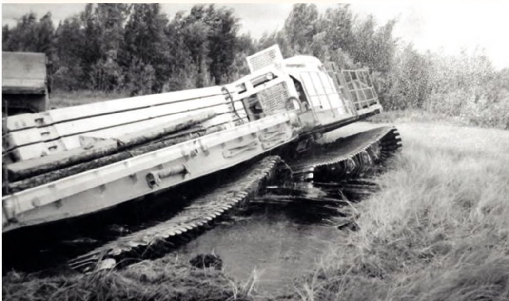
На испытаниях в окрестностях поселка Белоярский ШСГ401 загружали до полной грузоподъемности балластом из бетонных плит и испытывали в болотах, стремясь определить пределы проходимости
