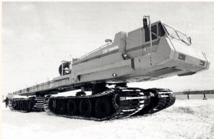
Строительный вездеход гусеничный СВ701 «Ямал» грузоподъемностью 70 т
