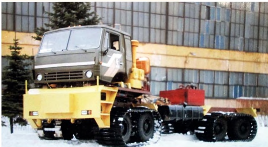
Шарнирно-сочлененное колесно-гусеничное шасси ШКГ101 грузоподъемностью 10 тонн
