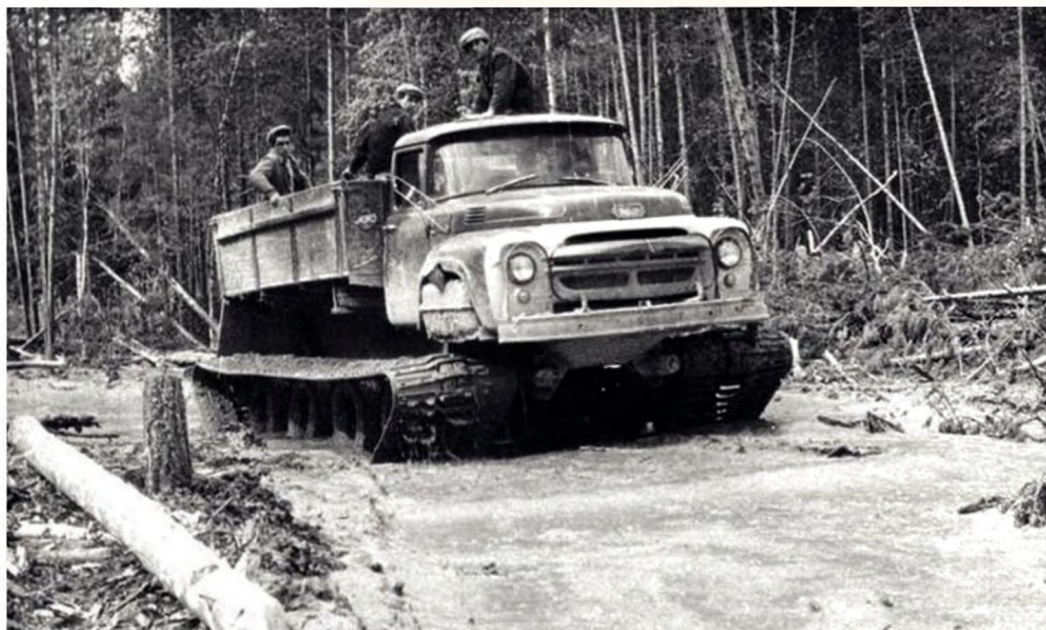
Болотоход «Витязь» В1 образца 1960 года. Грузоподъемность три тонны
