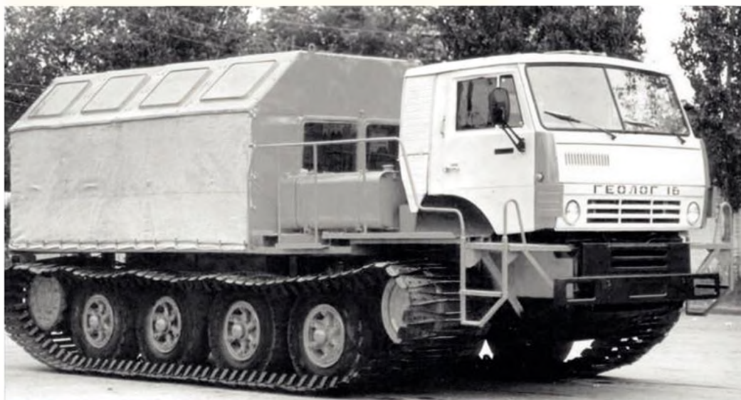
Транспортное средство сейсмовибратора ТСВ51 с гидростатической трансмиссией. Машина появилась в 1995 году
