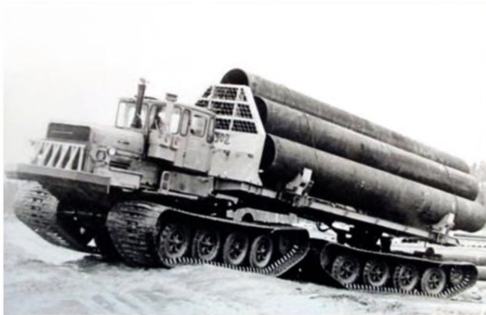
Болотоход БТ361 «Тюмень» грузоподъемностью 36 тонн
