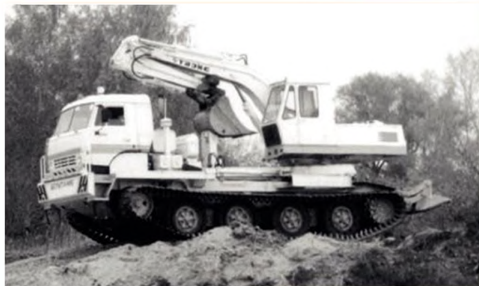
Экскаватор трубоукрепительный ЗОВ4221 на шасси снегоболотохода ШСГ10М
