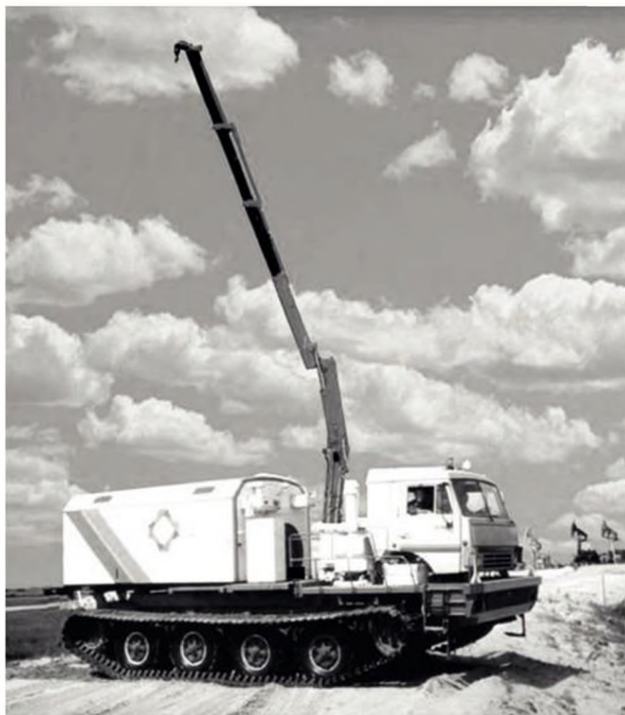
Агрегат энергетический передвижной АЭП Ю1 с шестью сварочными постами и генератором мощностью 100 кВт
