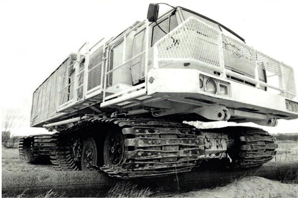
Созданное в 2002–2003 годах транспортное средство сейсмовибратора ТСВ301. Грузоподъемность шасси 15 тонн
