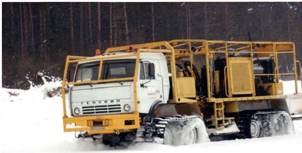
Сейсмовибратор на колесно-гусеничном шасси БКГ101 с гидростатической трансмиссией
