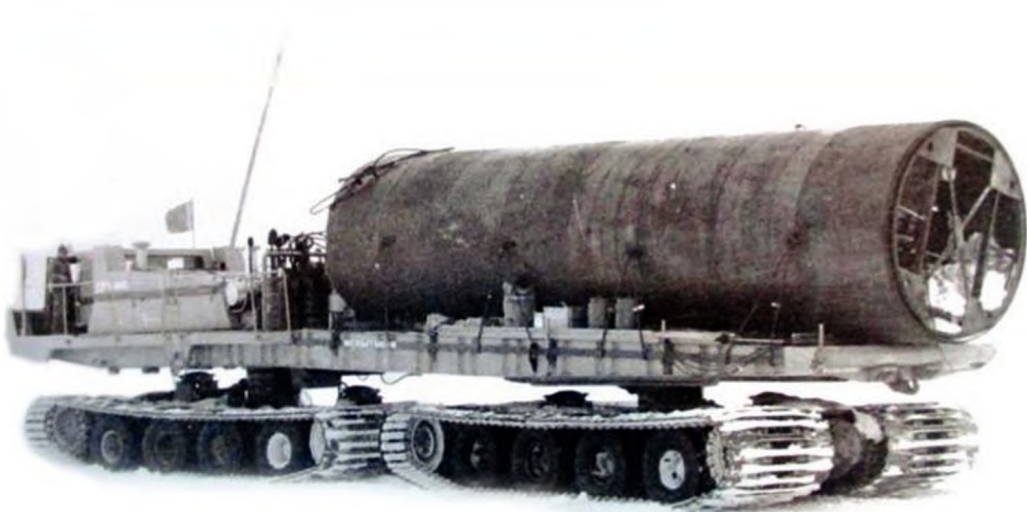
Перевозка 12-метровых заготовок топливных резервуаров массой 70 т на снегоболотоходе «Ямал»
