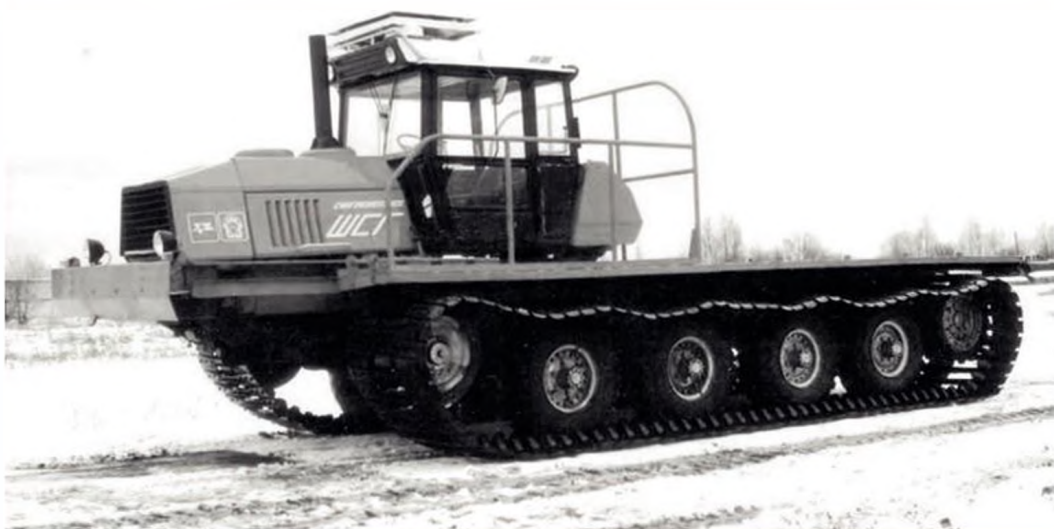
Шасси снегоболотоходное гусеничное ШСГ51, грузоподъемность 5 т
