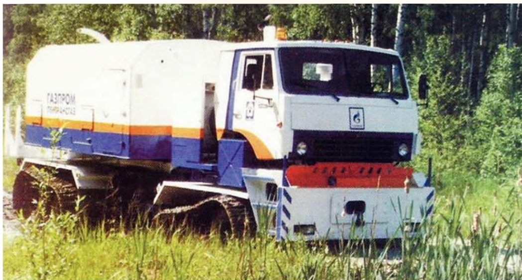
Сварочно-энергетический агрегат АЭП102 на шасси ШКГ101
