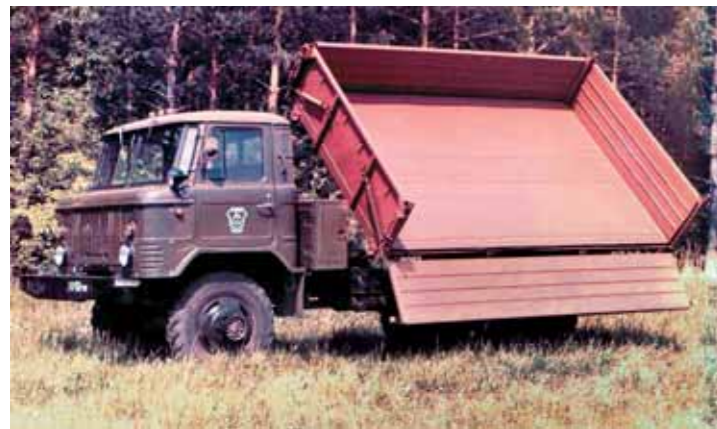
Второй опытный образец автосамосвала ГАЗ-САЗ-3511 со смещенными назад надрамным устройством и платформой от ГАЗ-САЗ-3507-02 с шарнирными запорами боковых бортов с регулируемым усилием на открывание-закрывание (сентябрь 1992 г.)
