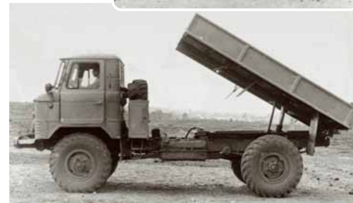
▼ Опытный самосвал САЗ на шасси ГАЗ-66-16 с платформой, установленной на предохранительный упор в поднятом положении
