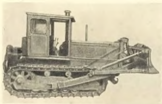
Рис. 1. Универсальный бульдозер ДЗ-17
