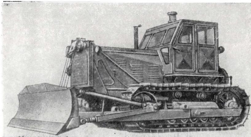
Бульдозер имеет универсальный привод с канатно-блочной системой управления, лебедку и отвал с ножами и толкателями.
