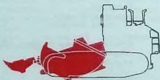
Процесс набора грунта в ковш
