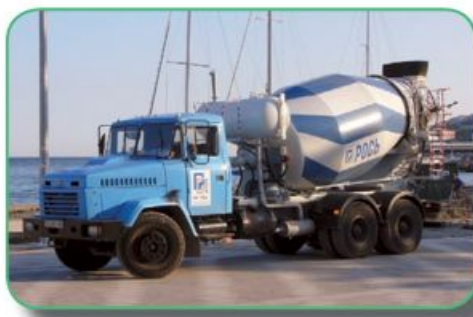
9-кубовый автобетоносмеситель КраЗ-7133Р4. 2006 г.
