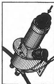
Рис. 19. Выключатель аккумуляторных батарей
