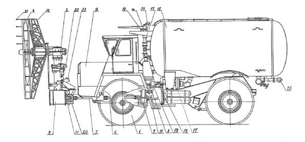
Установка местного проветривания УМП-15 представляет собой самоходный вентиляторороситель, предназначенный для использования в карьерах, имеющих автомобильные дороги. На раме 1, соединенной с рамой автомобиля, установлена приводная колонка 16 с винтом 18. Привод осуществляется от двигателя через карданные валы 2 и 3, редуктор 4, промежуточный карданный вал 5 и повышающую передачу автомобиля. Поворот винта в горизонтальной и вертикальной плоскостях обеспечивается гидравлическими
