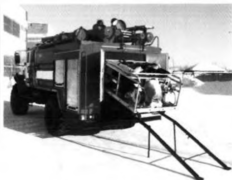
Контейнер с аварийно-спасательным оборудованием
