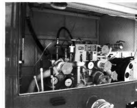
Пожарный насос НПЦ-40/100-4/400 с рукавной катушкой
