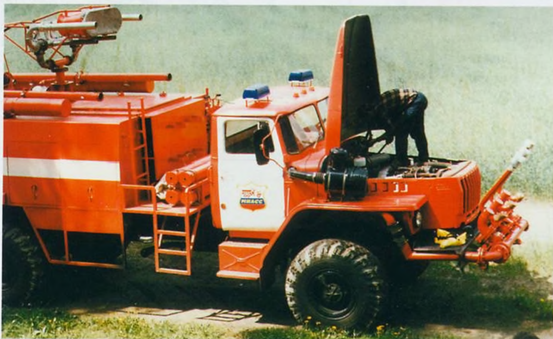
Этот аэродромный автомобиль базируется на шасси УРАЛ-4320-30 с дизелем ЯМЗ-238М2.
