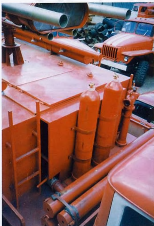
Передняя площадка кузова на первом образце автомобиля. На фото справа — задний борт и верх кузова машины с УКТП «Пурга».
