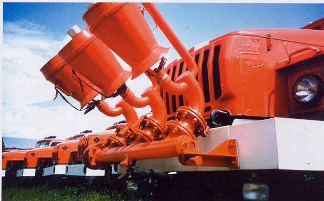
Основная отличительная особенность аэродромных пожарных машин — установка тушения пожаров самолетов УТПС-3 на переднем бампере автомобиля.
