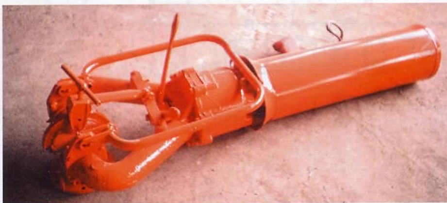
Лафетный ствол СПЛК-С40 отличается от СПЛК-С60 меньшей длиной ствола.
