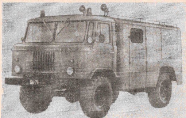
Автомобиль связи и освещения АСО-12(66), модель 90А
