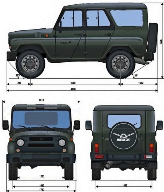
Рис. 1.2. Габаритные размеры автомобиля UAZ Hunter
