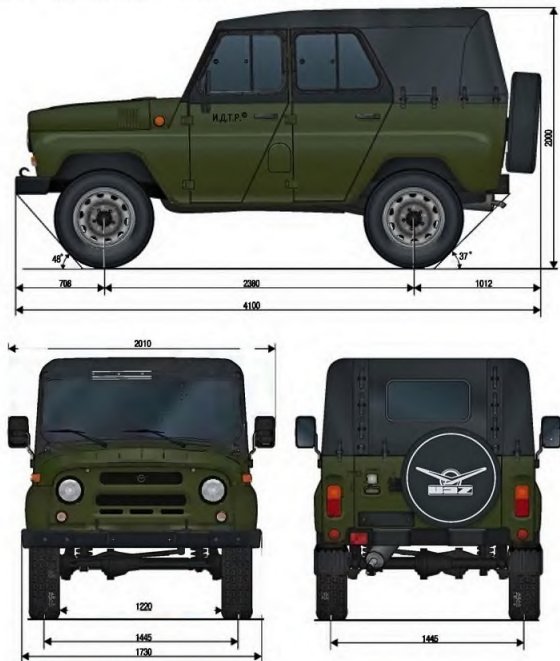
Рис. 1.1. Габаритные размеры автомобиля УАЗ-469
