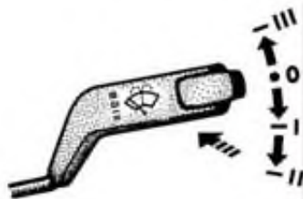
Рис.5.5. Положения рычага переключателя стеклоочистителя и стеклоомывателя (без звукового сигнала)
