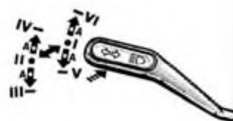
Рис. 5.3. Положения рычага переключателя указателей поворота и света фар (без звукового сигнала)
