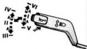
Рис. 5.2. Положения рычага переключателя указателей поворота и света фар (со звуковым сигналом)
