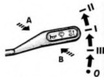
Рис.5.6. Положения рычага переключателя стеклоочистителя и стеклоомывателя (со звуковым сигналом)
