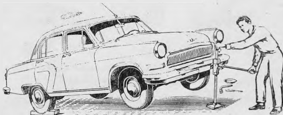
Фиг. 19. Установка домкрата
