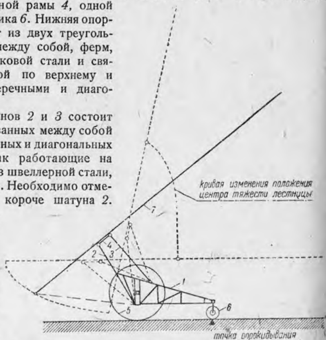
Рис. 165. Схема опорной базы съемной механической лестницы
