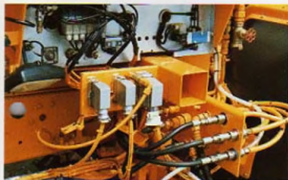
Schnelkupplungen für alle Versorgungsleitungen
