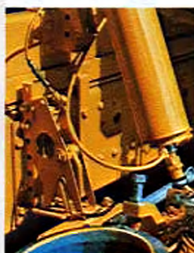
Automatische Arretierung des Kehraggregats
