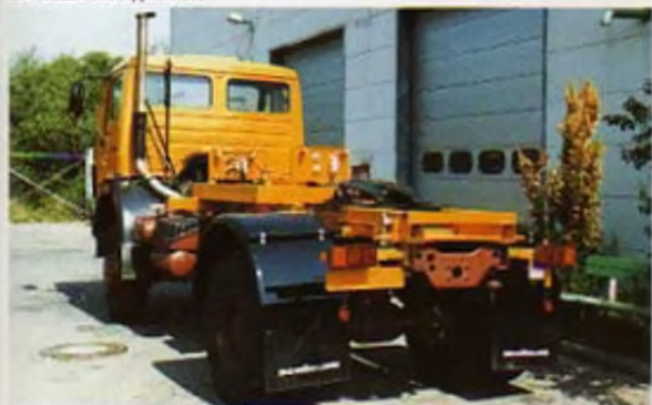
TSZ-Chassis mit Seitelflieger-Kupplung
