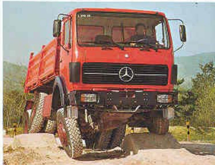
Auf eigenen Verwindungsstreifen werden Mercedes-Benz Nutzfahrzeuge in beladenem Zustand extreme Verwindung ausgesetzt, um auch in Situationen, die nicht immer sind als die Praxis, Robustheit und Langlebigkeit des gesamten Fahrzeugs zu testen.
