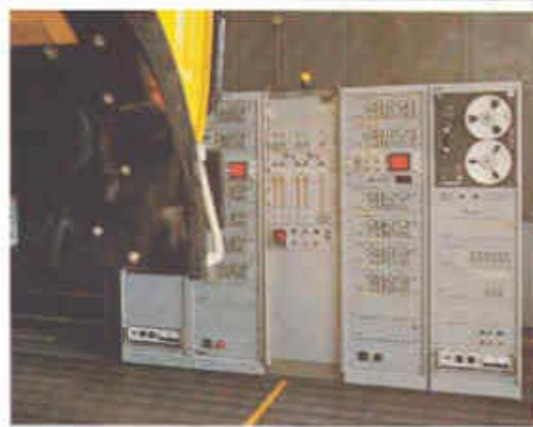
Die hochvibrationsstabileren Prüfstände sind zum großen Teil computergesteuert. Die enormen Drehmomente der Testaggregate können ohne Computer nicht erfaßt und ausgewertet werden.
