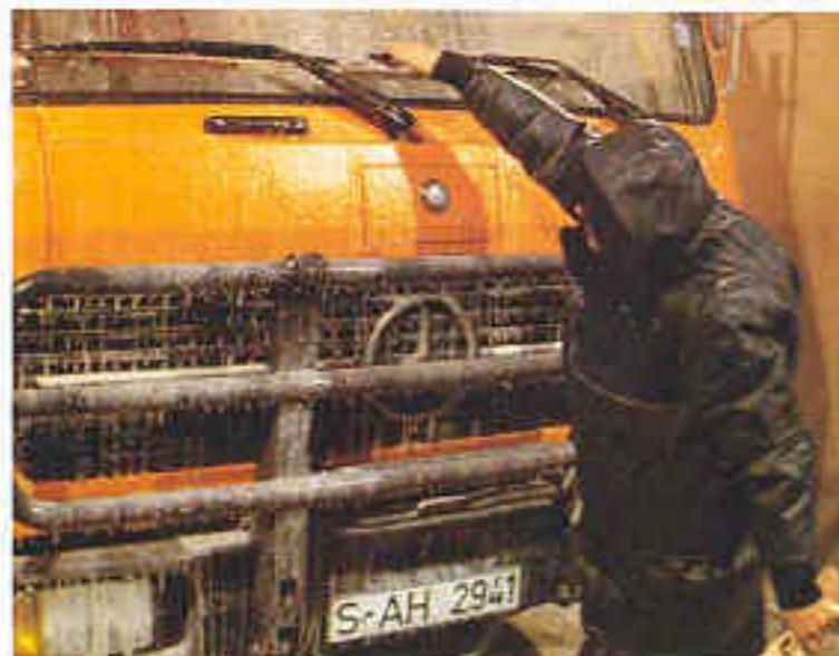
Auch bei minus 40 Grad Celsius muß der Motor problemlos anlaufen. Das wird in der Kältekammer geprüft.
