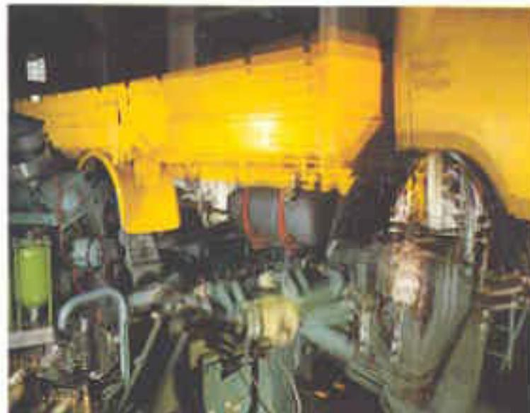
Die Fahrsimulationstechnik ermöglicht Dauertesten rund um die Uhr. Schneidewegstrecken werden auf Computerband gespeichert und servohydraulisch in die Anlage eingespielt.
