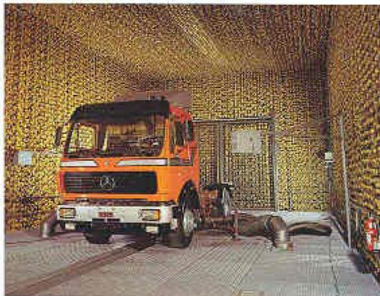
Simulationstests und Versuchsfahrten sind die richtige Basis für die ständige Weiterentwicklung der Technologie. In der aufwendig konstruierten Geräuschkammer werden alle Messungen vorgenommen, die mit der Geräuschemission eines Fahrzeugs zusammenhängen.
