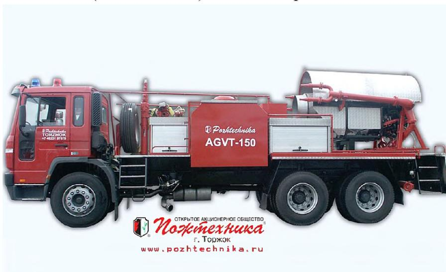
характеристика: боевой расчет - 3 чел., марка турбореактивного двигателя - ВК-1,, расход воды на тушение - 90 л/с., перемещение турбоустановки в вертикальной плоскости:  $-15^{\circ}$
