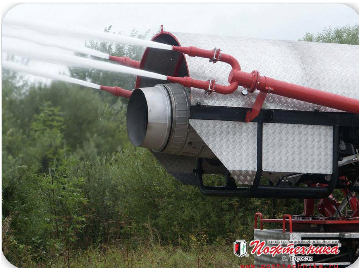
184 кВт (250 л.с). На автомобиле в качестве энергетического источника создания газоводяной струи использован авиационный турбореактивный двигатель. Управление установкой ТРД происходит с щита управления, расположенного в кабине водителя, управление движениями ТРД - с выносного пульта дистанционного управления. Для защиты автомобиля от воздействия высоких температур на нем предусмотрена система орошения.
