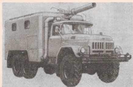
Рис. 1. Автомобиль пожарный рукавный АР-2(131), модель 133
