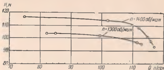
Рис. 4. Рабочая характеристика насоса ПН-110
