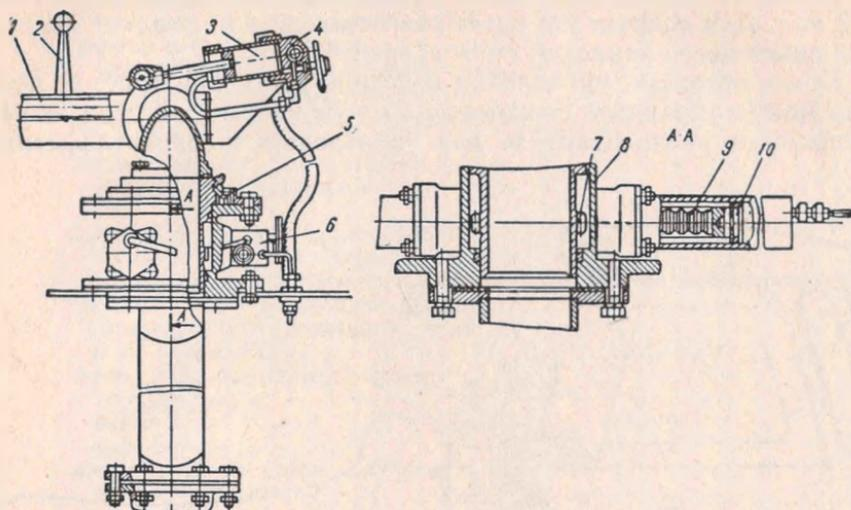
Рис. 3. Механизм управления лафетным стволом автоцистерны АЦ-40(375Н) Ц1А:
