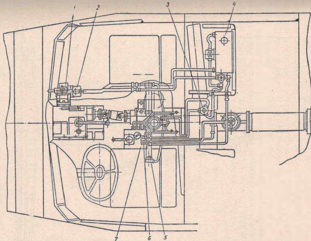
Рис. 2. Система гидроуправления автомобиля воздушно-пенного тушения АВ-40(375Н) Ц50А:
