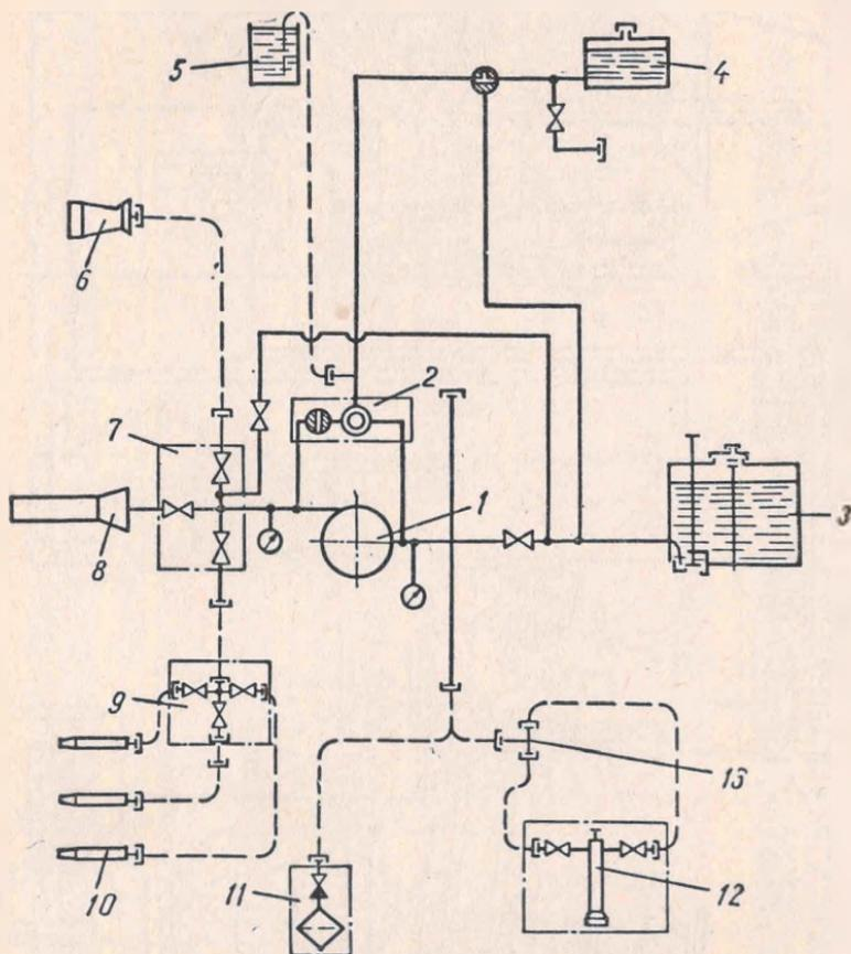
Рис. 7. Схема водопенных коммуникаций автоцистерны АЦ-40(375Н) Ц1А:
