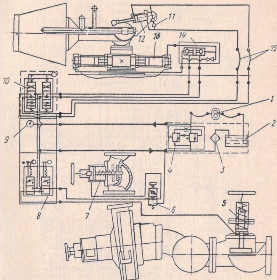
Рис. 6. Схема гидроуправления автоцистерны АЦ-40(375Н) ЦИА:
