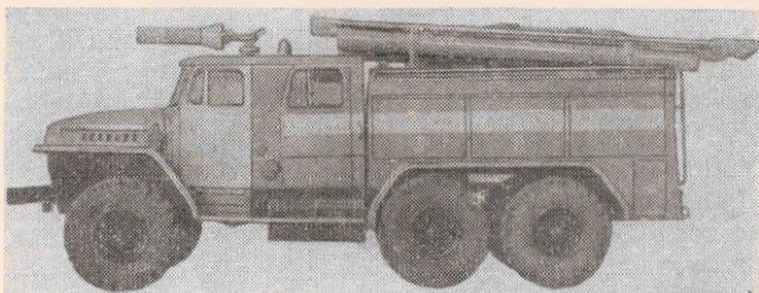
Рис. 1. Автомобиль пожарный воздушно-пенного тушения АВ-40(375Н), модель Ц50А
