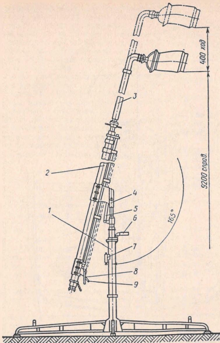
Рис. 3. Пенеподъемник автомобиля пожарного воздушно-пенного тушения АВ-40(375Н) Ц50А:
